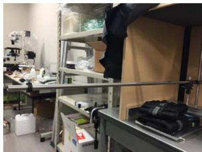
図 4 従来の荷重印加装置。横長の棒がてこ。
